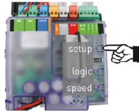
La porte doit effectuer une manœuvre d'ouverture et de fermeture au ralenti, puis une manœuvre d'ouverture à pleine vitesse.
