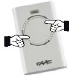
Appuyer sur P1 et **RESTER APPUYE** (jusqu'à la fin de la manœuvre suivante)
